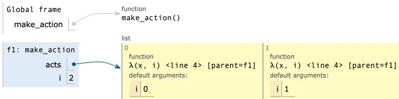
默认值参数在函数定义时求值，所以每次将一个lambda函数加入列表时，参数i都接受了一个默认值
